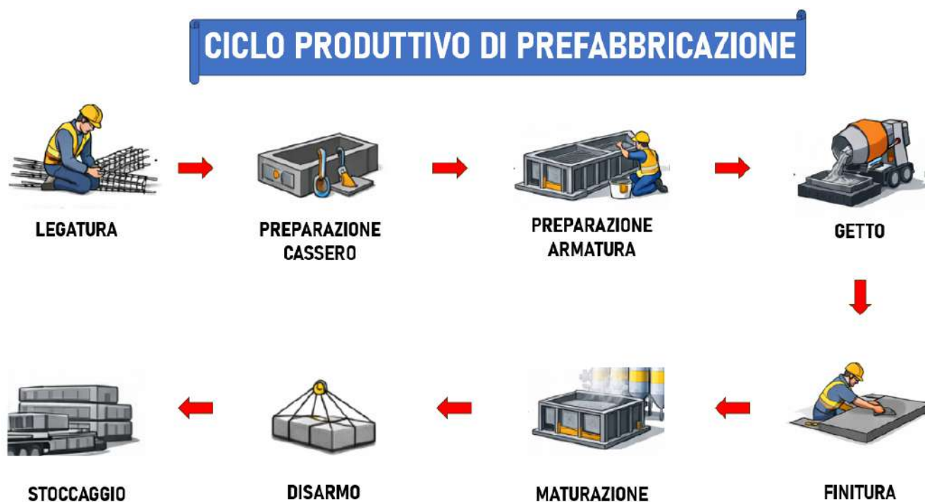
Figura 1 – Schema ciclo produttivo del prefabbricato
